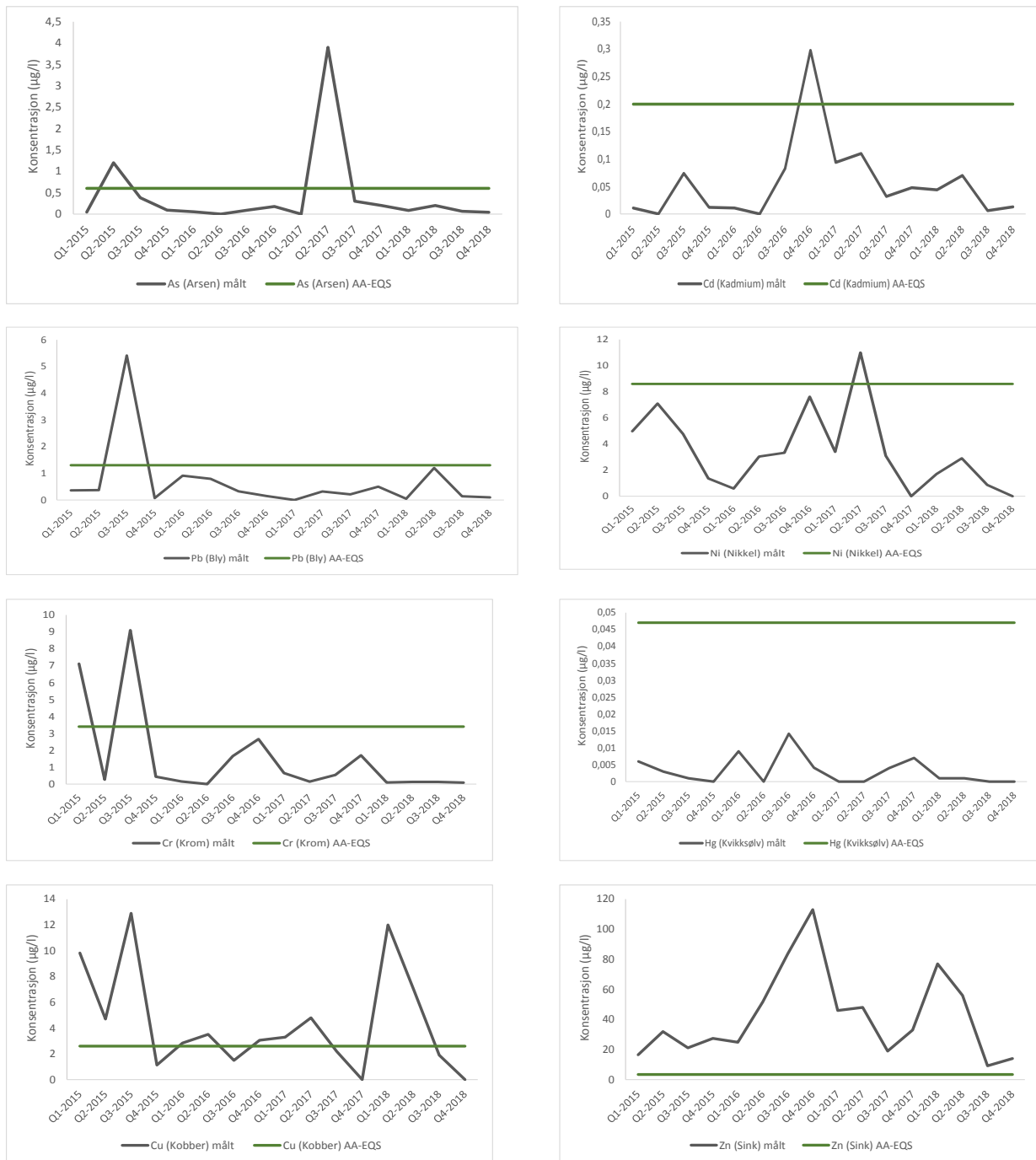
Figur 15 Konsentrasjoner (µg/L) av tungmetaller i utslippsvann fra AF Miljøbasen Vats fra 2015 til 2018. Grønn linje markerer grenseverdi for høyeste årlig gjennomsnittskonsentrasjon uten risiko for toksiske effekter AA-EQS, som tilsvarer tilstandsklasse II «god» tilstand i kystvann. Grenseverdien er definert for konsentrasjon i kystvann. Ettersom utslippsvannet raskt vil fortynnes, er sammenligningen inkludert kun for å illustrere nivåene i utslippsvann ift bakgrunnsverdier i uforurenset kystvann.
